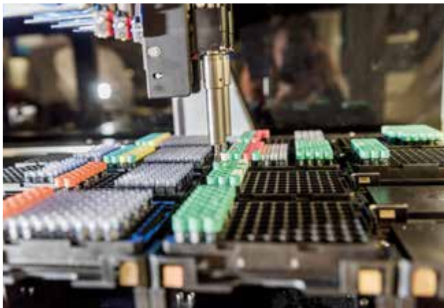
Ein Roboter lagert Flüssigkeitsproben ein, später werden sie bei minus 196 Grad in flüssigem Stickstoff gelagert.
